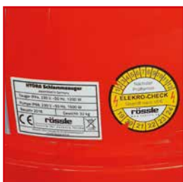
Elektrische Prüfung nach DIN
